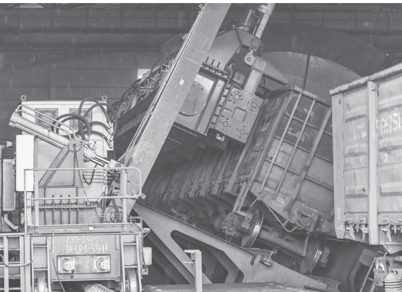
Уникальные тройные вагоноопрокидыватели могут разгружать по 8400 тонн угля в час.
